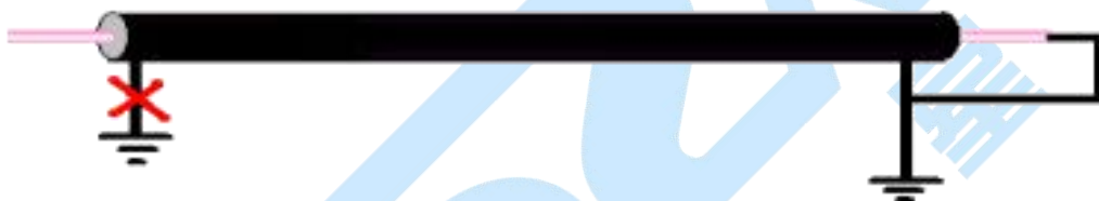
图 3 欲识别电缆测试前连线处理
